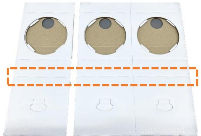
破線部を山折りし、立上げて成型
